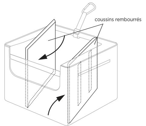
2. En positionnant la pochette vers l'avant, faire pivoter les coussins rembourrés vers les parois latérales et les fixer solidement avec les bandes en tissu à boucles et crochets.
