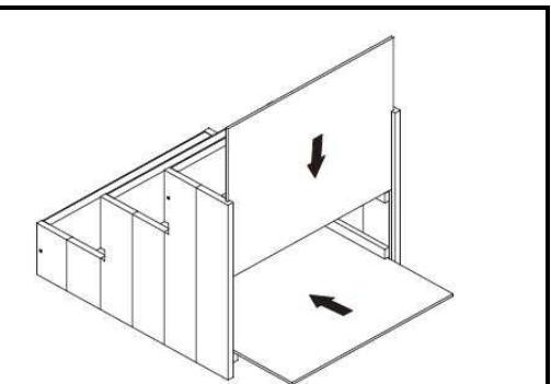
**Setzen Sie den Boden und die Rückwand ein.**
