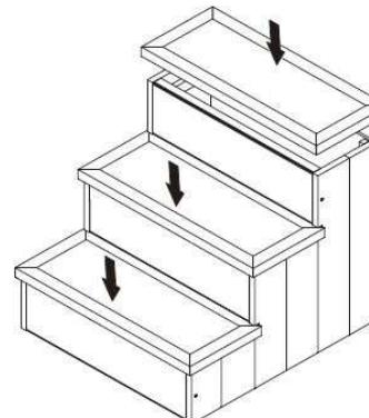
**Setzen Sie die Stufen ein.**
