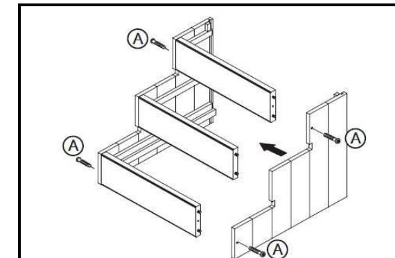
**Verschrauben Sie die linke und rechte Seitenwand mit den Vorderteilen.**
