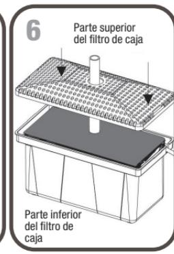
**Paso 6.** Coloque la tapa sobre la parte inferior del filtro de caja. Luego, trábelas.
